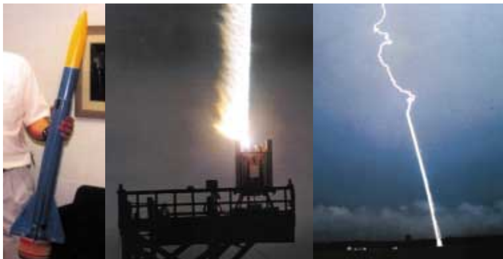
Bild 3. Triggerstation Camp Blanding, Florida/USA. Triggerung positiver Blitze mittels kleiner Raketen, die einen dünnen, geerdeten Metalldraht nach sich ziehen
